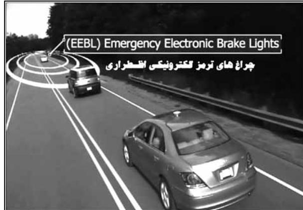
می‌تواند به راننده برای جلوگیری از برخورد به عقب یک خودروی دیگر کمک کند اگر یک وسیله ی دیگر جلوتر از آن‌ها توقف کرده است یا اساساً آهسته رانندگی می‌کند.
